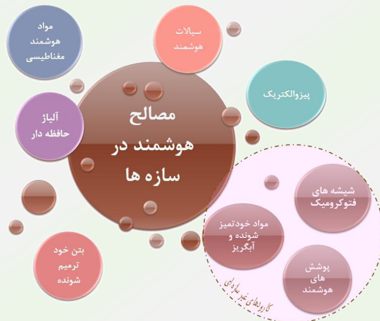
شکل ۴: انواع مصالح هوشمند پر کاربرد در سازه‌ها
